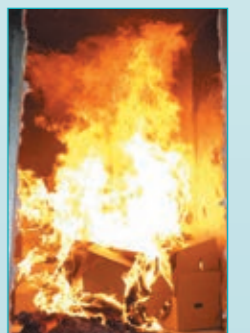
埼玉県三芳町倉庫火災を想定した実験
